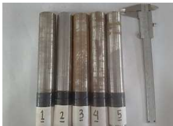
Gambar 2. Material 1) AISI 1020, 2) AISI 1045, 3) AISI 1090, 4) AISI 4340, 5) D2.
