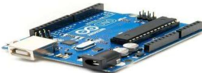
Arduino adalah mikrokontroler papan tunggal open source yang berasal dari platform kawat yang dirancang untuk memfasilitasi penggunaan elektronik di
