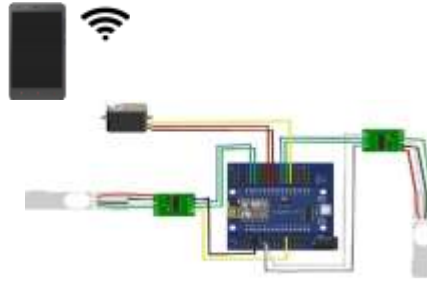
Gambar 8. Desain Prototype Otomatis Pemberi Obat Pasien Covid
