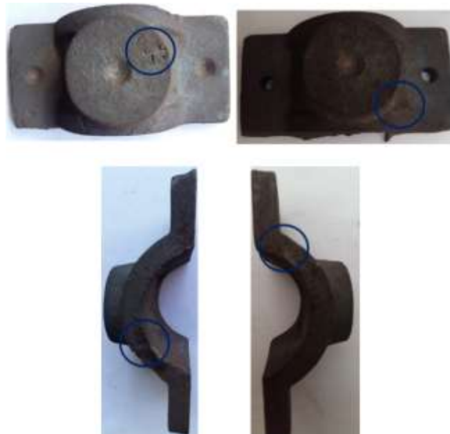
Gambar 5 Cacat cor pada clamp saddle
