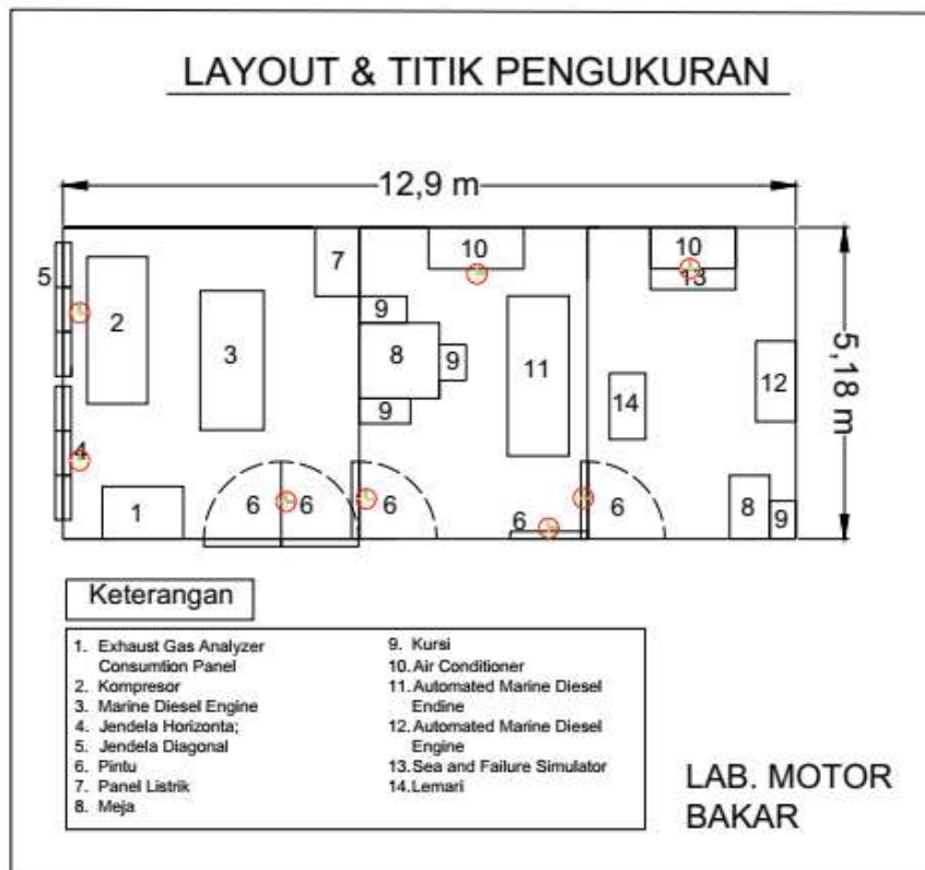
Gambar 1. Layout dan titik pengukuran laboratorium motor bakar
